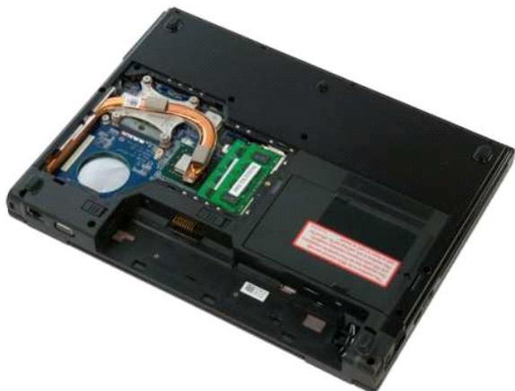
4. Abra cuidadosamente con la punta de los dedos los ganchos de fijación situados en cada extremo del conector para módulos de memoria hasta que el módulo de memoria se expulse. Repita el procedimiento para todos los módulos de memoria que tenga el ordenador.
