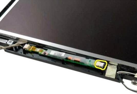
6. Desconecte el cable de datos del inversor del ensamblaje de la pantalla.
