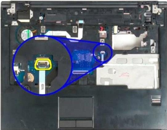
11. Retire el cable de datos del lector de huellas digitales del seguro para cable.
