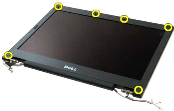
4. Quite los seis tornillos que fijan el embellecedor al ensamblaje de la pantalla.
