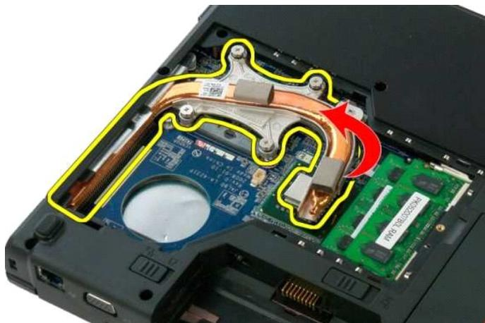
7. Deslice el disipador de calor hacia el centro del ordenador y, a continuación, levántelo y extráigalo del ordenador.
