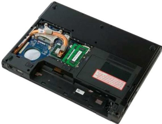
5. Afloje los cuatro tornillos cautivos que fijan el disipador de calor al ordenador.
