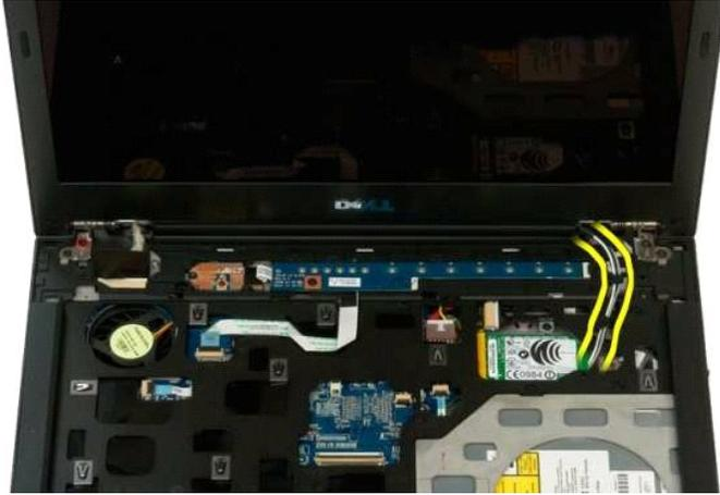
9. Desconecte el cable de datos de la pantalla de la placa base.
