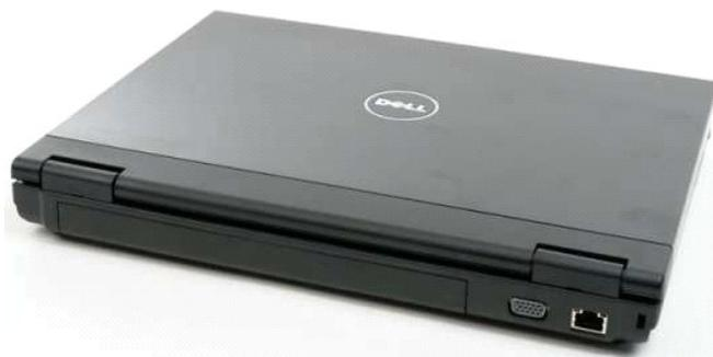
3. Utilice un instrumento de plástico acabado en punta para levantar con cuidado la parte posterior de la cubierta de las bisagras y separarla de la base del ordenador.
