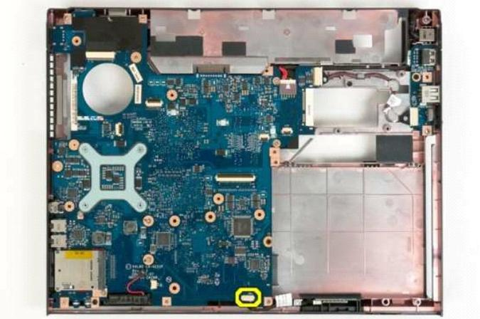
19. Desconecte el cable de datos de la tarjeta USB de la placa base.
