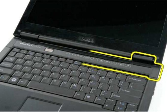
5. Continúe separando la cubierta de las bisagras del ordenador de derecha a izquierda y, a continuación, extráigala.
