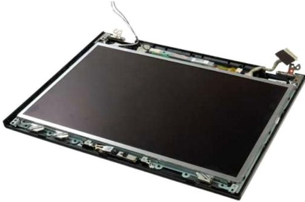
5. Quite el tornillo que fija la cámara de la pantalla al ensamblaje de la pantalla.
