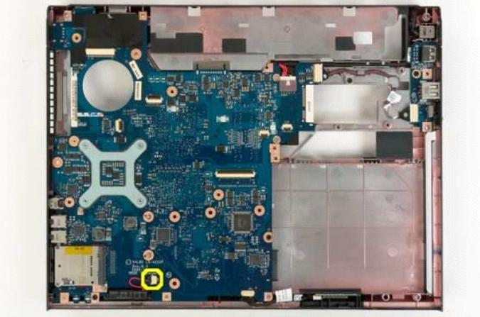
18. Desconecte el cable de datos de la placa base.
