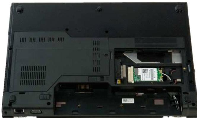
7. Desconecte los cables de antena de la tarjeta WLAN.
