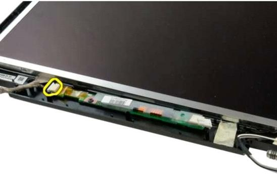
7. Extraiga el inversor de la pantalla del ensamblaje de la pantalla.
