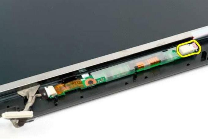
6. Desconecte el cable de datos del ensamblaje de la pantalla.
