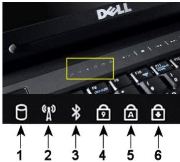
Indicadores luminosos de estado del dispositivo situados en la parte central de la cubierta de las bisagras.
