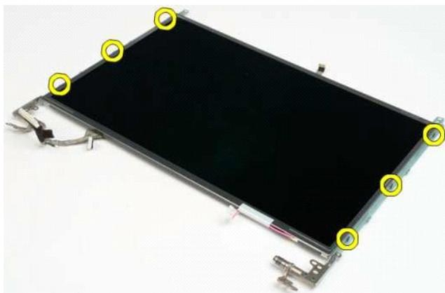
7. Separe las bisagras del ensamblaje del panel de la pantalla.
