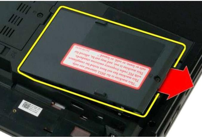
6. Deslice la unidad de disco duro hacia el lado derecho del ordenador para desenganchar la unidad de su conector.
