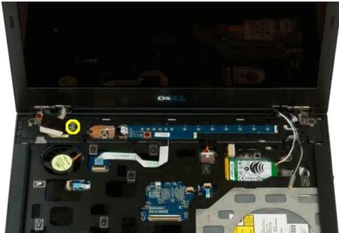
11. Quite los cuatro tornillos que fijan el ensamblaje de la pantalla a la base del ordenador.
