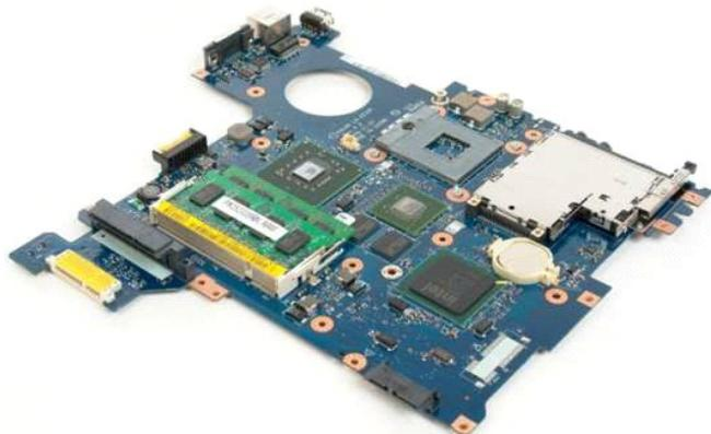
13. Inserte un instrumento acabado en punta en la ranura y levante con cuidado la batería de tipo botón haciendo palanca.
