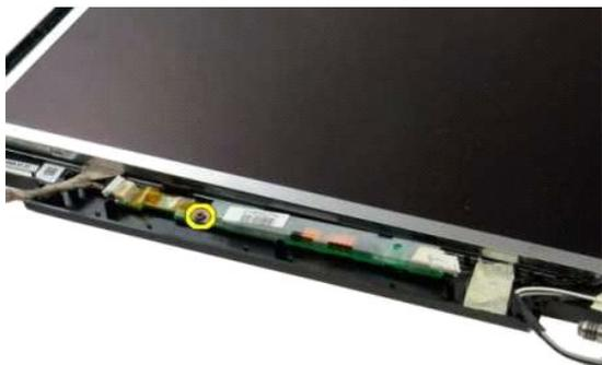
5. Desconecte el cable de alimentación del inversor del ensamblaje de la pantalla.
