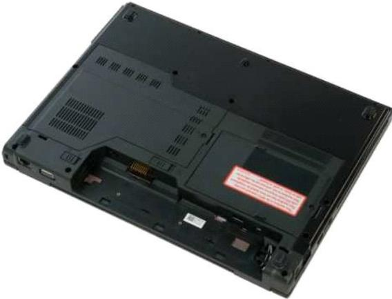
3. Afloje el tornillo cautivo que fija el panel de acceso de la unidad de disco duro a la parte inferior del ordenador.
