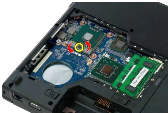
9. Levante el procesador para extraerlo del zócalo sin doblar ninguna de sus patas.
