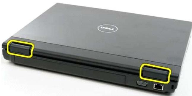
4. Separe la cubierta de las bisagras de la base del ordenador empezando por el lado derecho.
