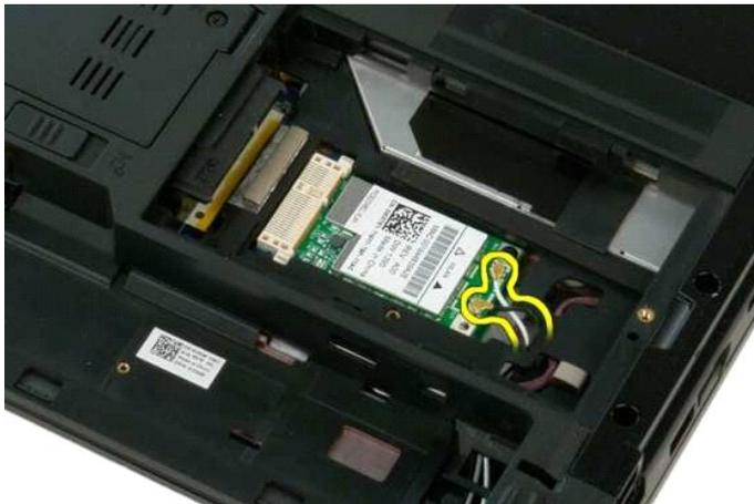
5. Quite el tornillo que fija la tarjeta WLAN a la placa base.
