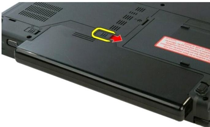
4. Deslice la batería hacia la parte posterior del ordenador y extráigala.
