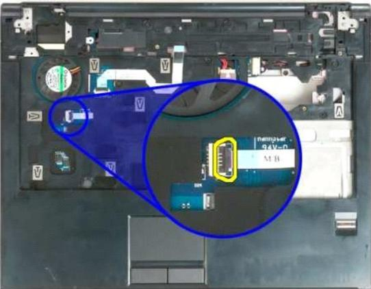
13. Retire el cable de datos de la superficie táctil del seguro para cable.
