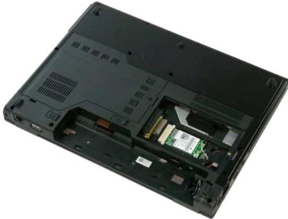
4. Desconecte los cables de antena de la tarjeta WLAN.
