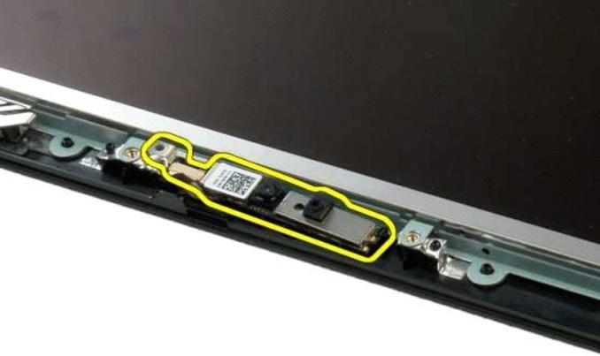
7. Desconecte el cable de datos de la cámara de la pantalla.
