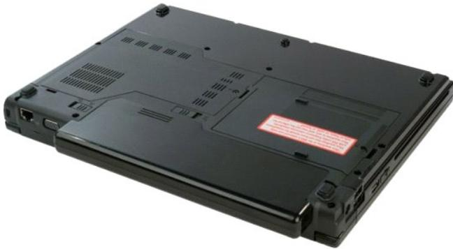
2. Deslice el pestillo de fijación de la batería hacia la izquierda para separarlo de la batería.
