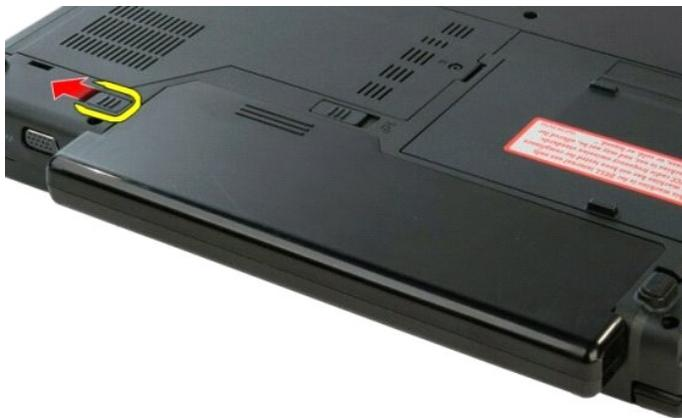
3. Deslice el pestillo de la batería de la parte central hacia la derecha.
