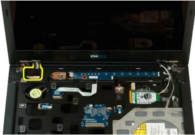
10. Afloje y suelte el tornillo de conexión a tierra de la pantalla del ordenador.
