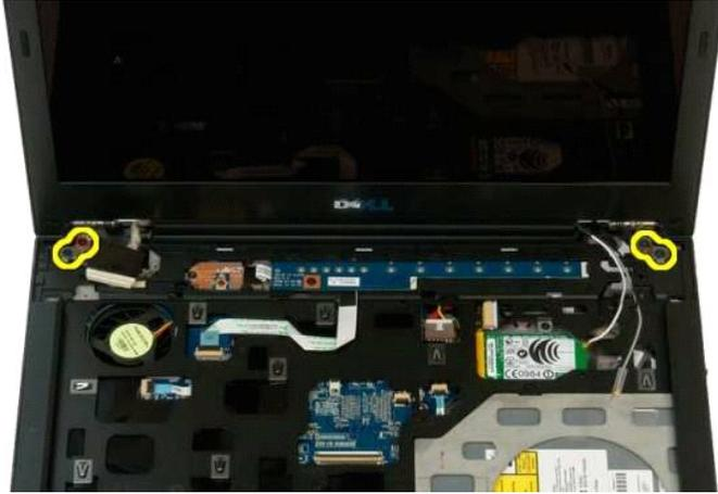
12. Levante y extraiga el ensamblaje de la pantalla del ordenador.
