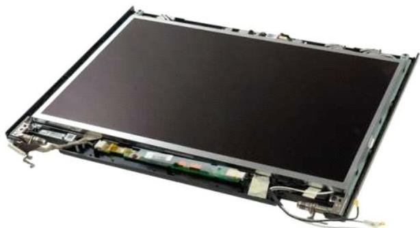
4. Quite el tornillo que fija el inversor de la pantalla al ensamblaje de la pantalla.
