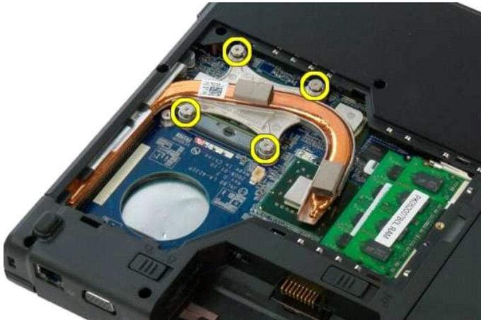
6. Levante el borde del disipador de calor más cercano al centro del ordenador.
