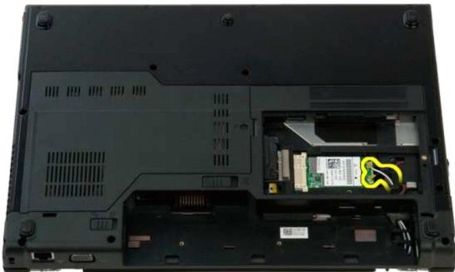
8. Separe los cables de antena de la placa base.
