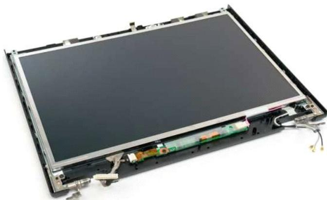
4. Quite los dos tornillos que fijan el panel de la pantalla LCD al ensamblaje de la pantalla.
